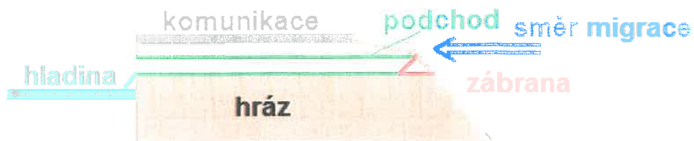
Obr 3 – Návrh trvalé zábrany na hrázi rybníka Nohavice (pohled kolmo ke směru migrace)
